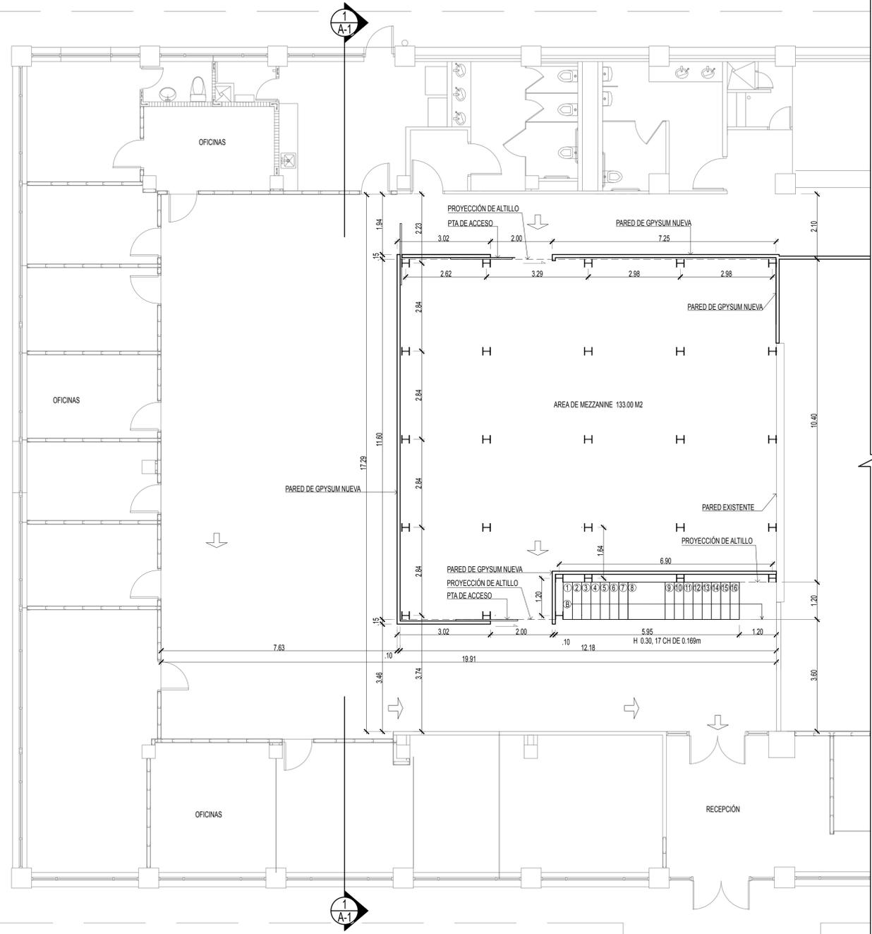
**AMPLIACIÓN DE ESQUEMA DE ALTILLO DESMONTABLE**
