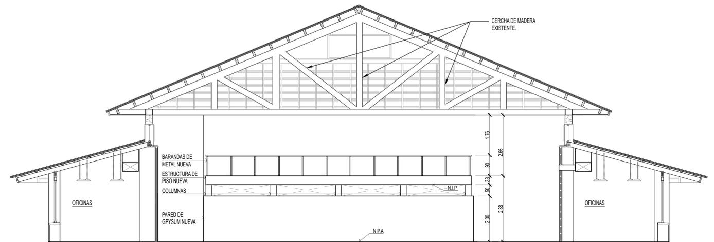
**SECCIÓN EXISTENTE DE EDIFICIO Y ELEVACIÓN LATERAL DE NUEVO ALTILLO DESMONTABLE**
